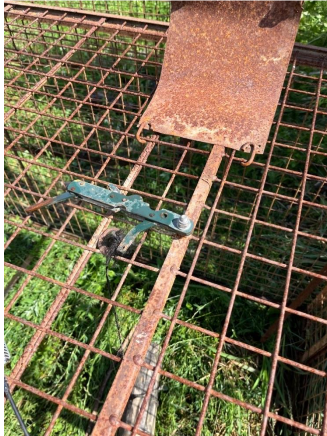
Abbildung 17 Selbstauslösemechanismus einer Kastenfalle (eigene Darstellung)
